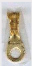
COD. 213.0104 TERMINAL ELECTRICO (IM 126) (DIAMETRO INTERNO=4,5mm,(5/32)" DIAMETRO EXTERNO=8,4mm LONG.=21m/m ESPESOR=0,71m/m)
