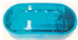
COD. 280167 PAR FAROL DE SEÑAL LATERAL MULTIVOLTAJE 10 LED AZUL
