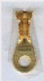
COD. 213.0103 TERMINAL ELECTRICO (IM 124) (DIAMETRO INTERNO=3,8mm,(3/8)" DIAMETRO EXTERNO=8,4mm LONG.=21m/m ESPESOR=0,71m/m)
